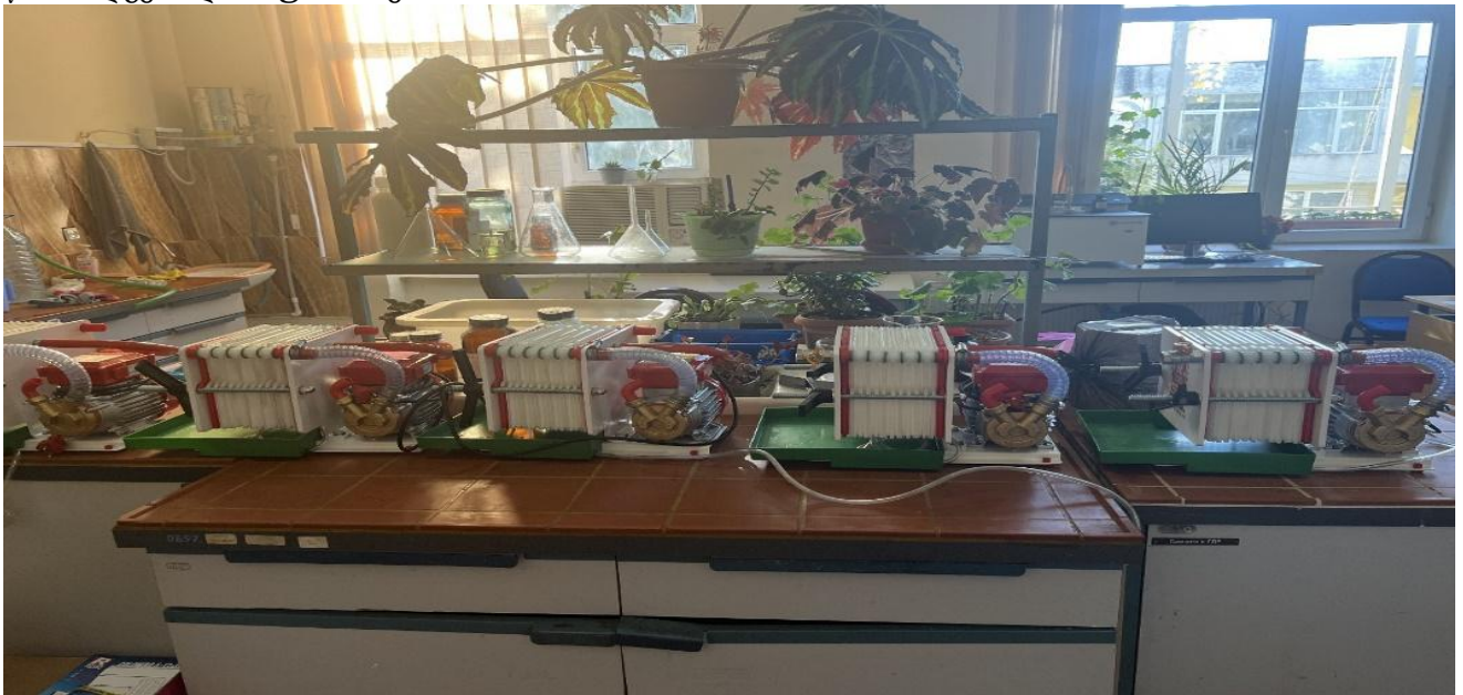
სურ: 1. მიკროფილტრაციული დანადგარები, აწყობილი სხვადასხვა ფორის სიდიდის ფთოროპლასტის მასალისაგან დამზადებული მიკროფილტრაციული მემბრანებისაგან.
