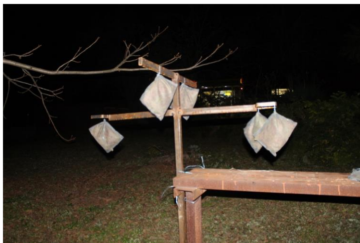
სურ. 4. საკვლევ ტერიტორიაზე დამონტაჟებული ეგრეთ წოდებული „სფაგნუმის ჩანთა“.
